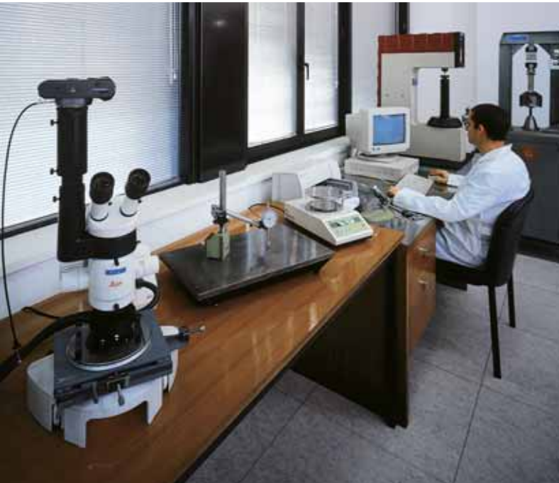
Im Vordergrund: Raumbild-Weitwinkelmikroskop mit Makrographie-Fotoröhre.
