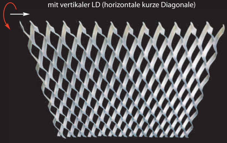
Ansicht der schrägen Masche mit Drehbiegung an der Oberseite
